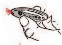
PREMERE IL TASTO CH1 E DOPO 1 SECONDO IL TASTO SX DEL RADIOCOMANDO A PER 3 SEC , QUANDO IL LED DELLA RICEVENTE RIMANE ACCESO RILASCIARE ENTRAMBI
