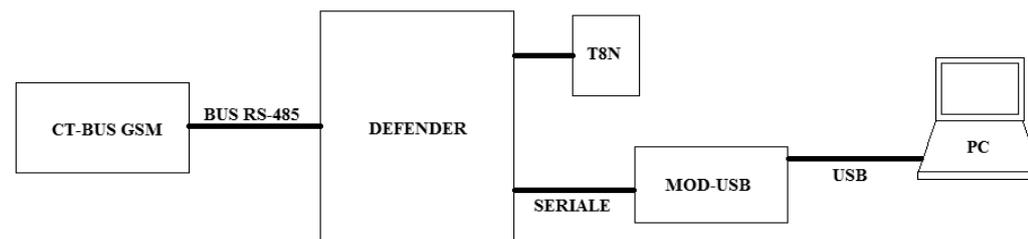
Il combinatore telefonico CT-BUS GSM deve essere prima acquisito dalla centrale come indicato nel capitolo 4.1 dopodiché, una volta effettuato il collegamento con il PC, è possibile scaricare sul PC la configurazione della centrale e del combinatore per le modifiche e configurazioni desiderate.
