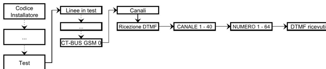
Una volta avviato il test il combinatore contatta il numero telefonico selezionato e rimane in attesa di toni DTMF. Durante questo tempo premere i tasti da 0 a 9, il tasto \* ed il tasto # del telefono contattato e controllare che vengano correttamente riprodotti nel display della tastiera T8N o nel display della tastiera a bordo centrale. Nel caso in cui il test fallisca verificare il livello del segnale del combinatore nel menù dedicato.
